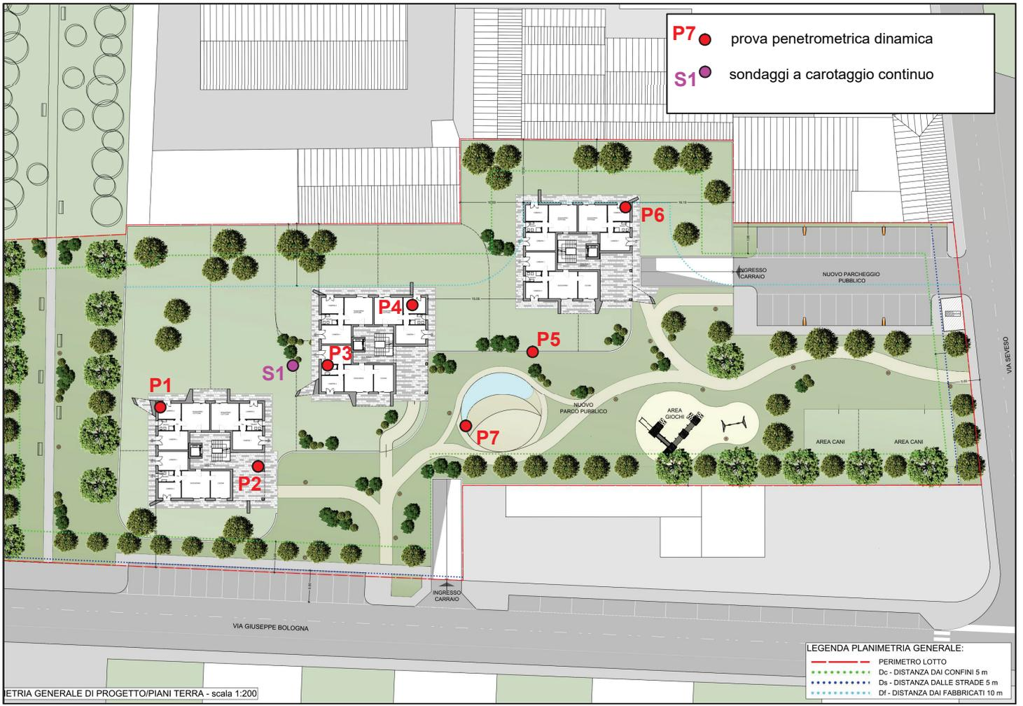
**P7** ● prova penetrometrica dinamica
