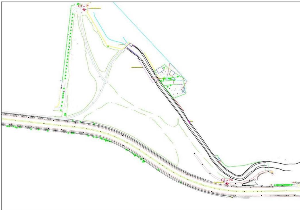
Figura 2-1 Ubicazione piezometri
